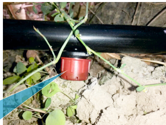
Наружный эмиттер (капельница) с регулируемым расходом воды
